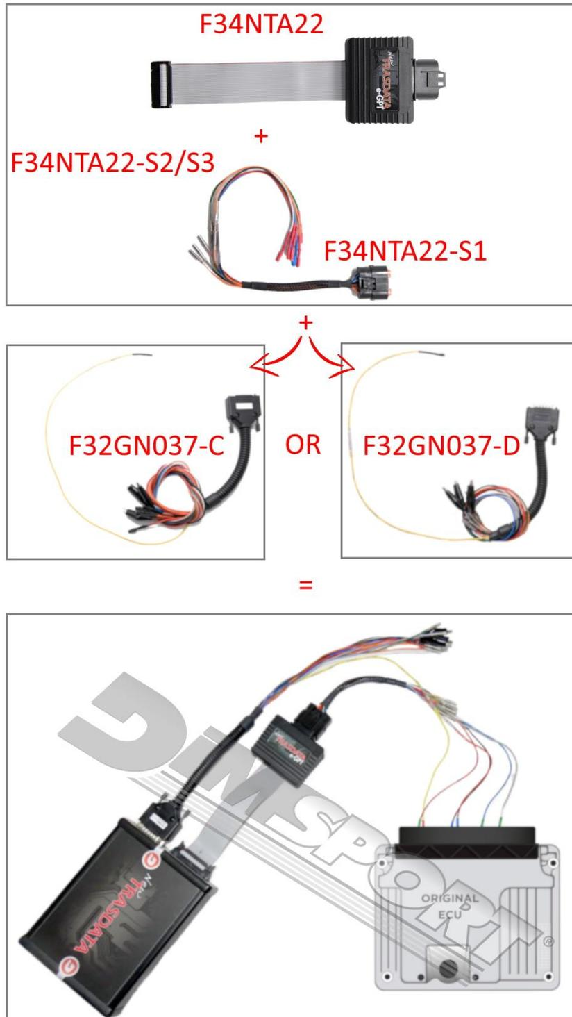
**ECU CONNECTOR / CONNETTORE ECU / CONNECTEUR ECU
