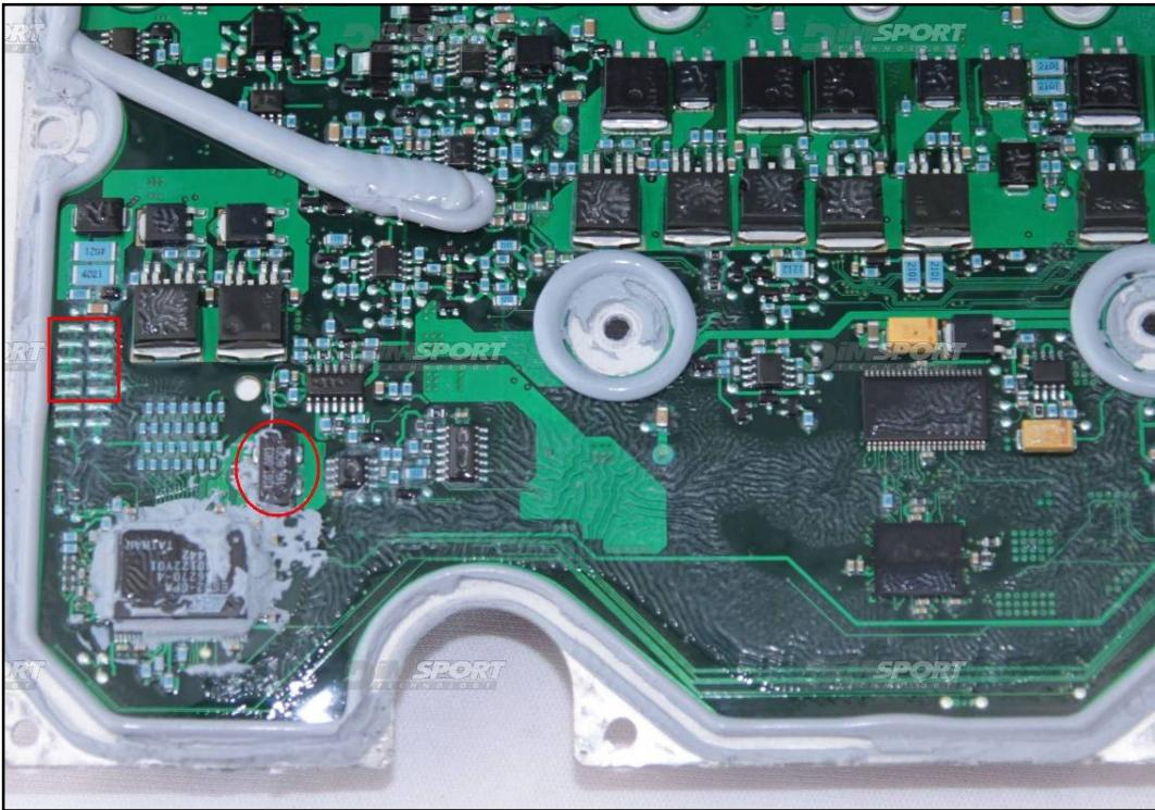
Per poter effettuare la lettura in BDM è necessario ponticellare il quarzo come da foto seguente
